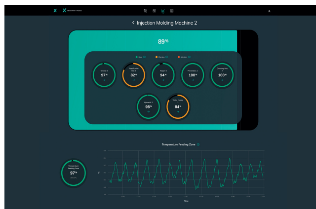
Bild 5. Die KI-basierte Prozessüberwachung für Spritzgießmaschinen und Peripheriegeräte soll helfen, den CO 2 -Fußabdruck kunststoffverarbeitender Unternehmen zu senken. © technotrans
