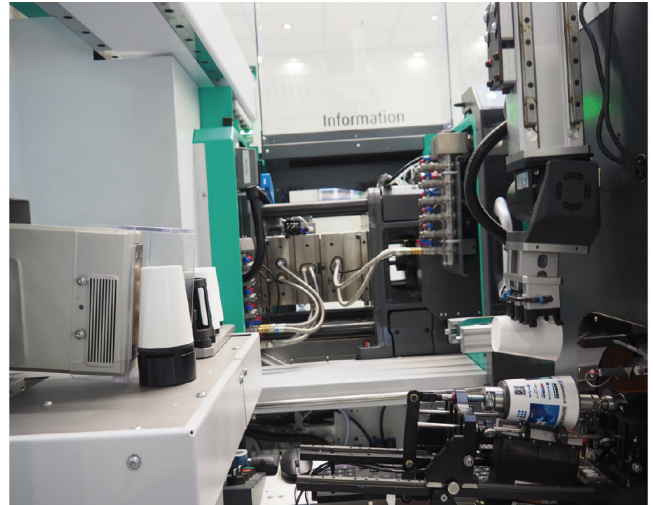
Bild 6. Eine Openair-Plasma-Vorbehandlung (links) macht eine brillante und beständige Bedruckung von Trinkbechern aus recyceltem PP möglich.
