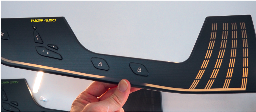
Bild 3. Dieses Seitentürpanel wird durch Folienhinterspritzen mit Prägephase hergestellt.
